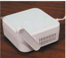
①「エアロコ」のサービスで使用するCO<sub>2</sub>センサー
